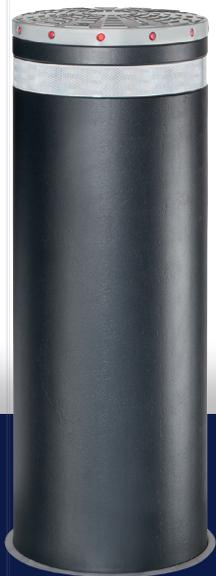
1. La classe M30-P1 indique en effet que la borne FAAC J355 F est en mesure d'arrêter, avec un seul mètre de pénétration totale (P1) un camion de 6 800 kg lancé à 50 km/h (= 30 m/h).
