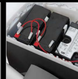
Fonctionnement assuré en cas de coupure du courant au moyen de batteries de secours en option. Carte chargeur de batterie de série.
